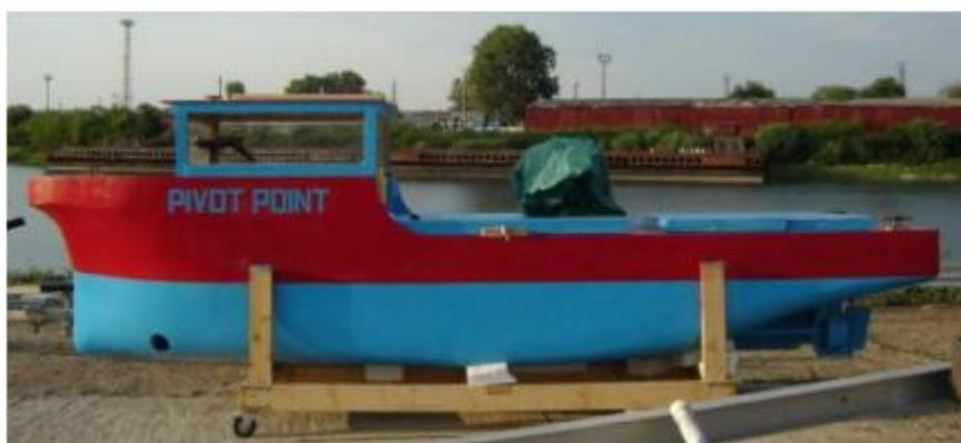
**Figura 4: Modelo tripulado de um navio na escala 1/12 (fonte: Universidade Marítima de Constantza)**
