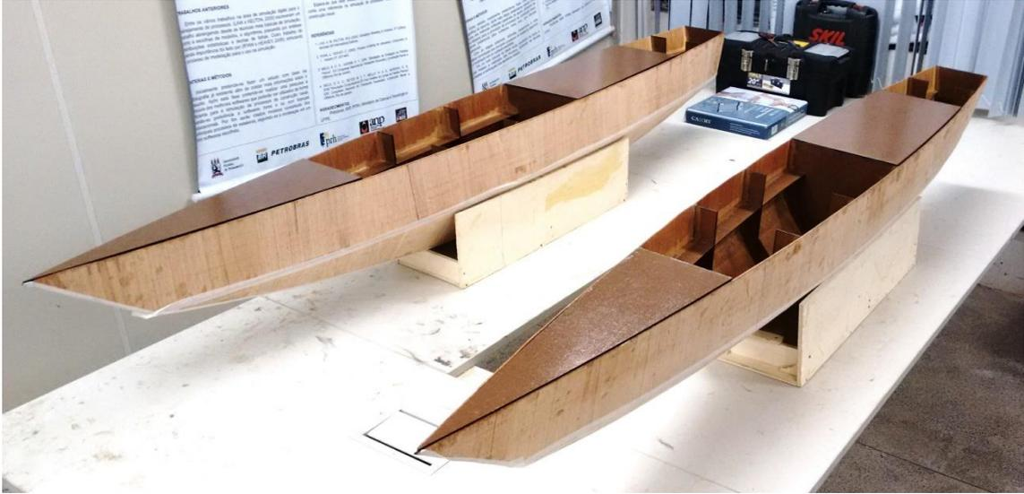
**Figura 66** - Finalização do processo de laminação e impermeabilização interna dos cascos.
