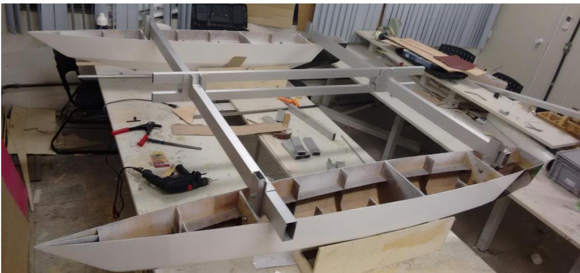
**Figura 70** - Instalação e fixação da plataforma do catamarã aos cascos.
