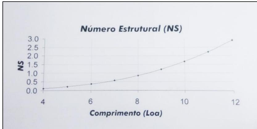
**Figura 46** - Gráfico utilizado para obtenção do *número estrutural* da embarcação.
