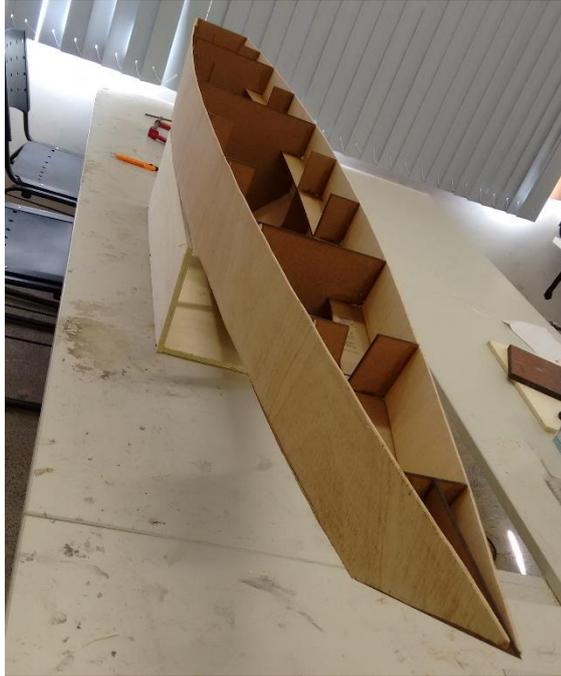
**Figura 64** - Representação da montagem do casco finalizada.
