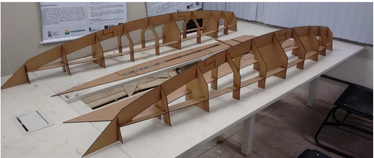
**Figura 59** - Montagem da estrutura interna dos cascos.
