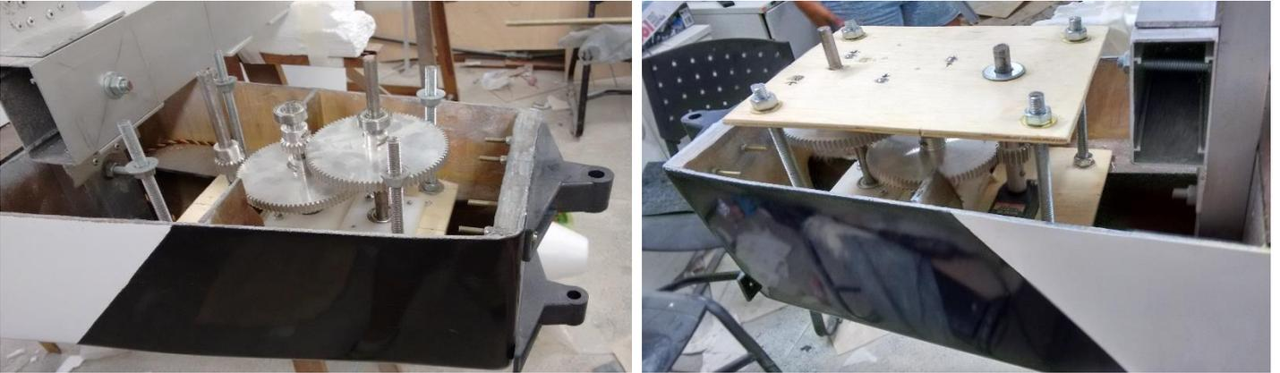
**Figura 71** - Instalação das engrenagens do sistema de governo e suportes dos lemes.
