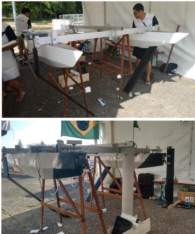
**Figura 72** - Representação da instalação dos *hidrofólios* e lemes da embarcação.
