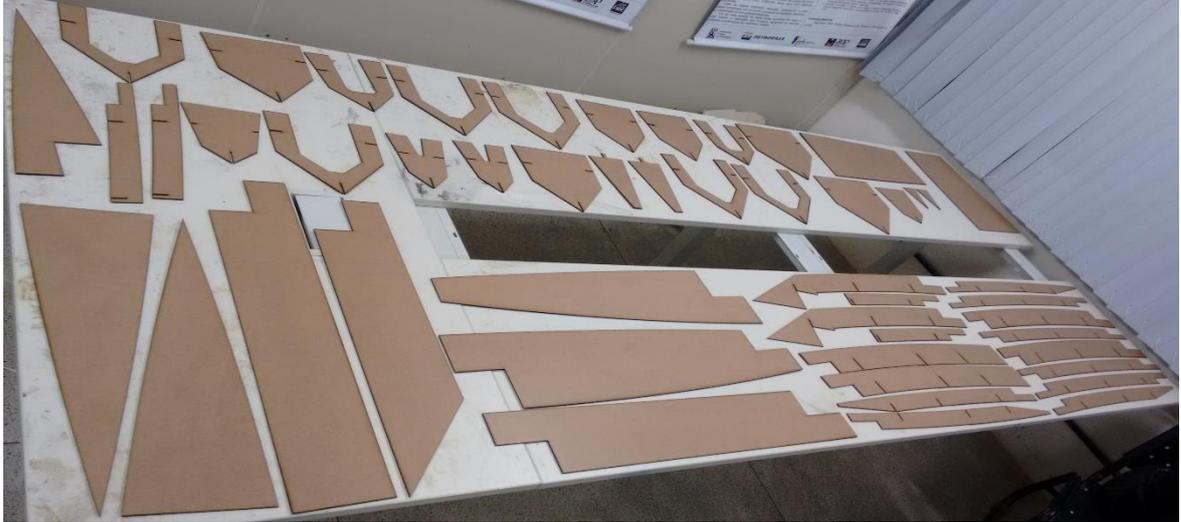
**Figura 57** - Representação dos componentes estruturais dos cascos.
