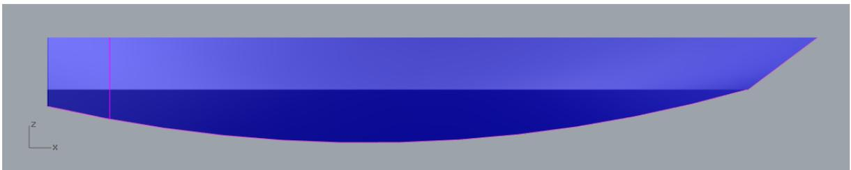
**Figura 19** - Representação da igualdade as cotas do convés da embarcação.
