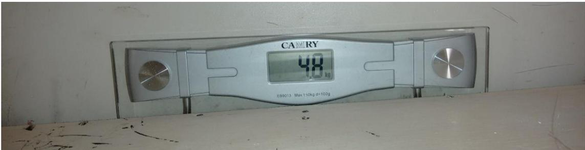
**Figura 67** - Pesagem final dos cascos após finalização da montagem e laminação interna.
