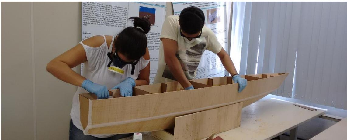
**Figura 65** - Início do processo de laminação e impermeabilização dos cascos.
