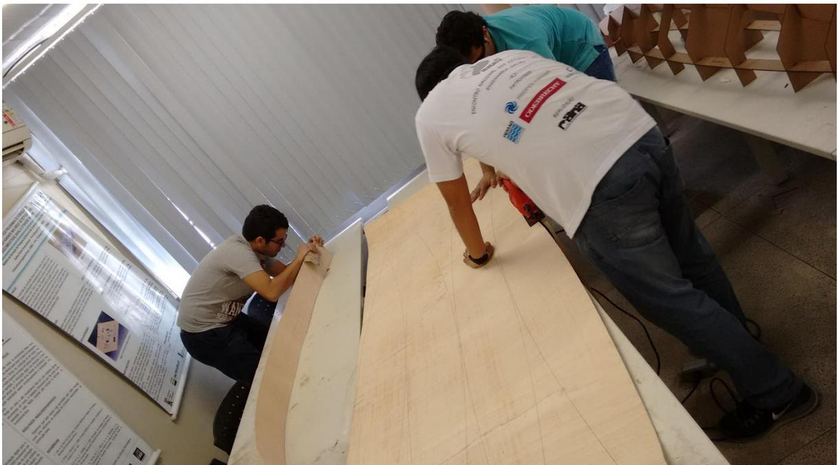
**Figura 61** - Marcação e corte das peças em compensado flexível de madeira *sumaúma*.
