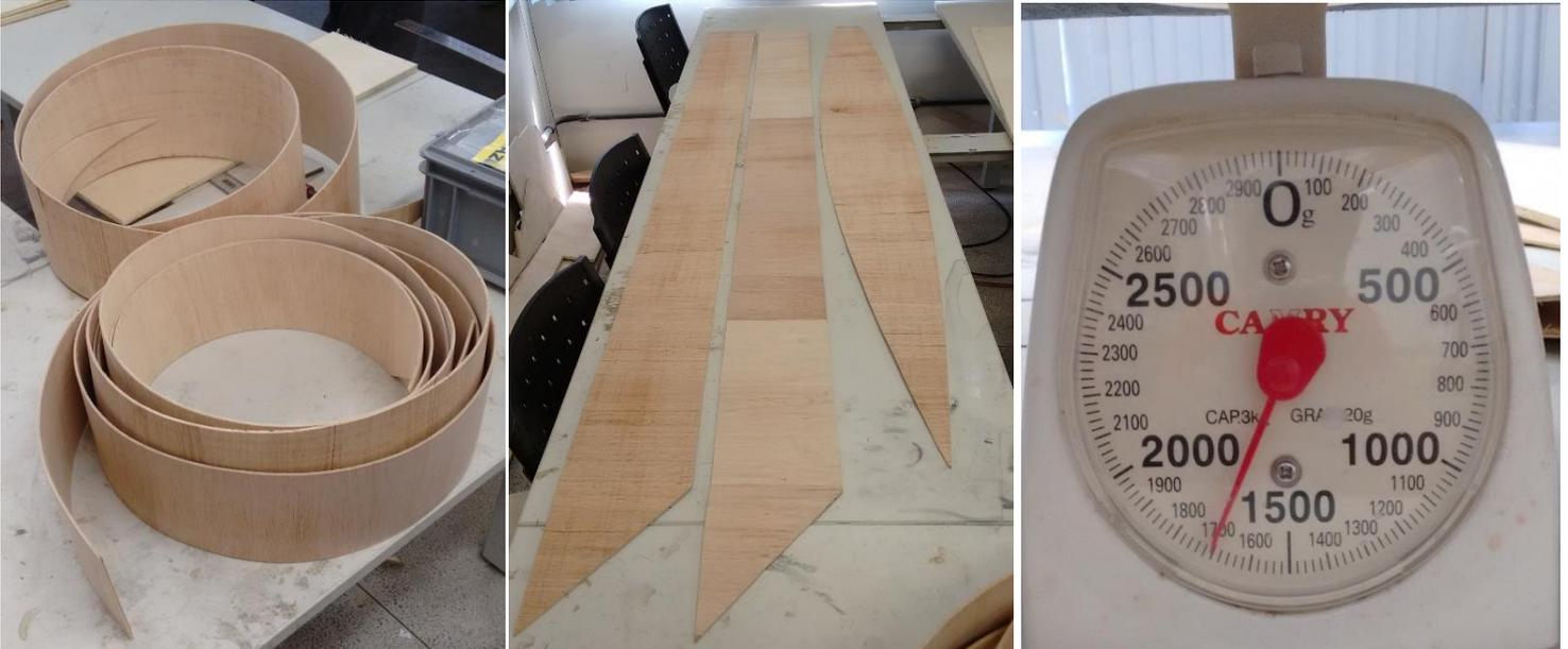
**Figura 62** - Pesagem do *costado* e *fundo* dos cascos após o corte.
