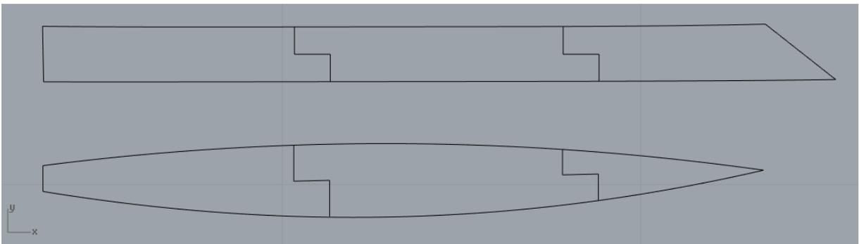
**Figura 22** - Representação da planificação das superfícies de *costado* e *fundo* dos cascos.
