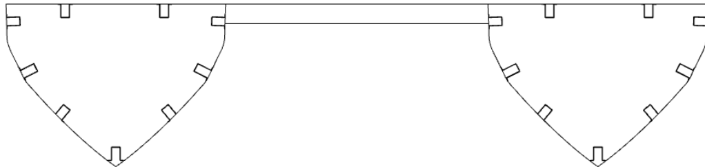
Figura 40: Vista transversal da embarcação com os reforços
