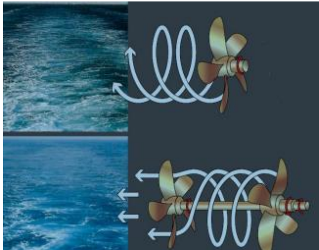
Figura 7: Representação do escoamento com propulsão individual e propulsão contra-rotativa
