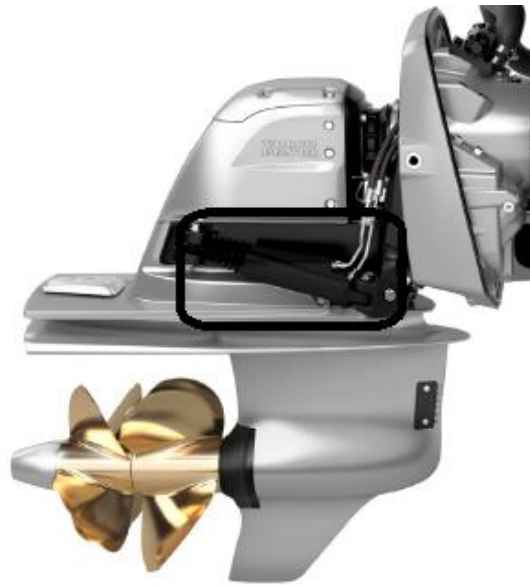
Figura 17: Demonstração do sistema hidráulico do motor
