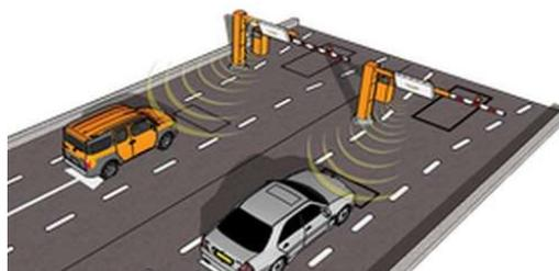
**Figura 02:** Ilustração funcionamento das antenas de captação por tecnologia RFID.
