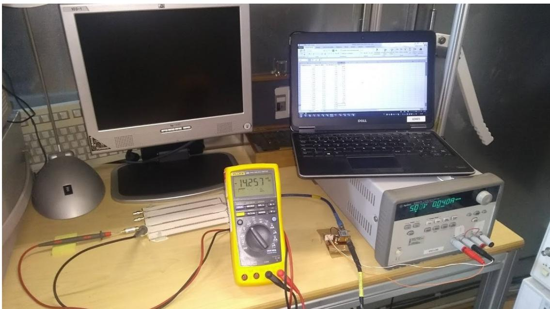
**Figura 3.28** – Medida com o detector coaxial de micro-ondas com a placa do Sistema IFM sem a etapa DC integrada.
