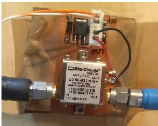
Figura 3.4 – Amplificador de RF utilizado no projeto do IFM.
