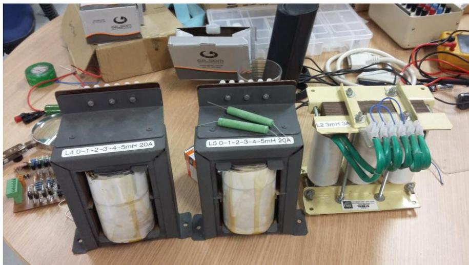
Figura 5.23 - Elementos passivos utilizados como impedância da linha de transmissão.
