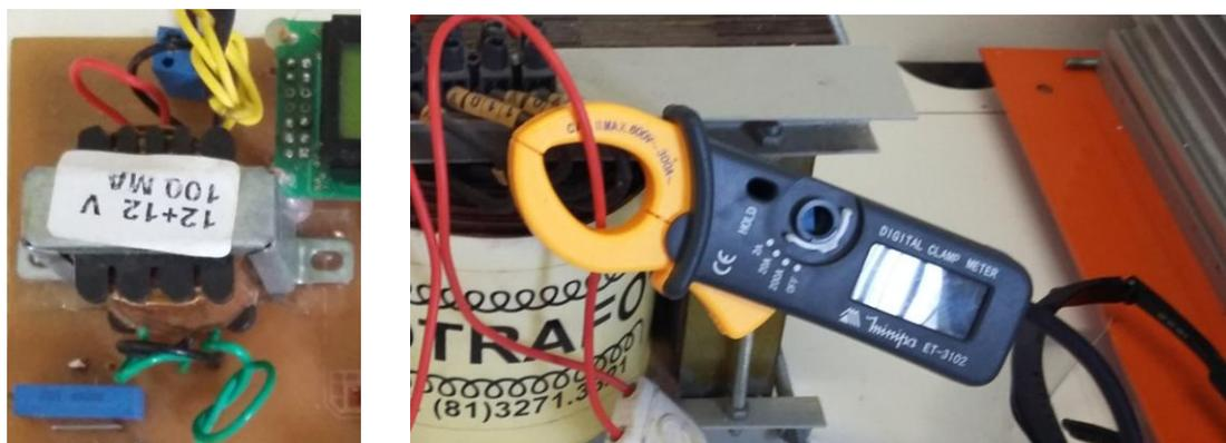
Figura 5.16 - TP e TC utilizados pelo módulo de medição e controle.
