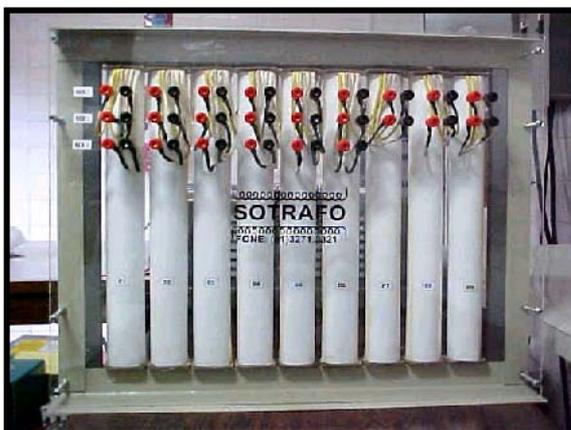
Protótipo 2 – Reator com ligação paralela dos enrolamentos (GEC)
