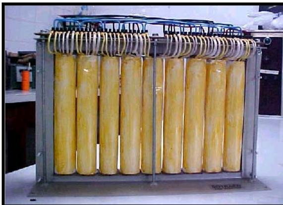
Protótipo 1 – Reator com ligação série dos enrolamentos
