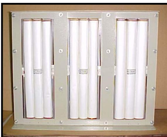
Protótipo 3 – Reator com ligação paralela dos enrolamentos (TTU)
