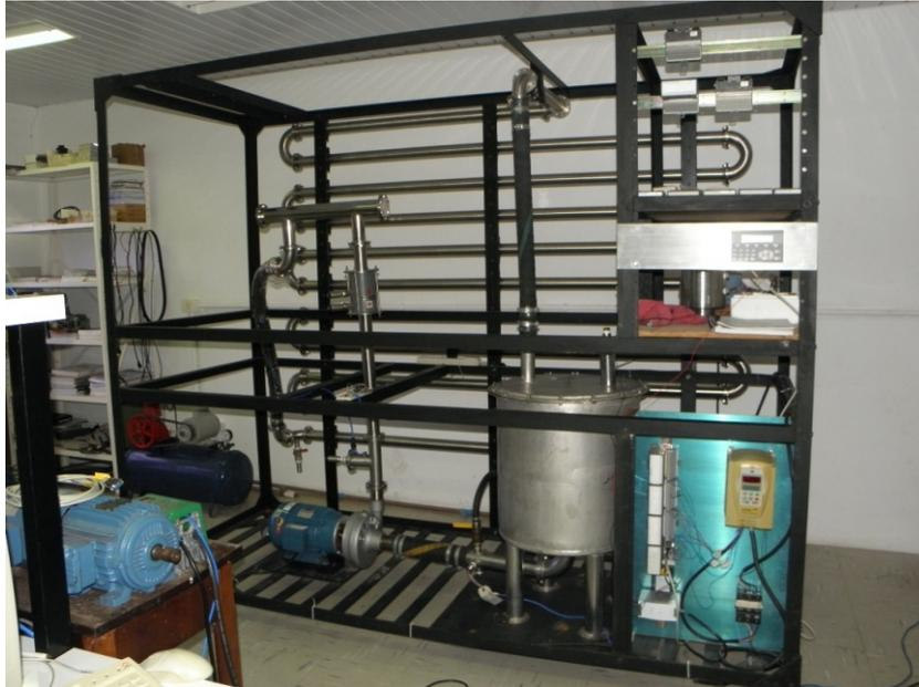
Figura 3.8: Planta para ensaio em medidores de vazão.
