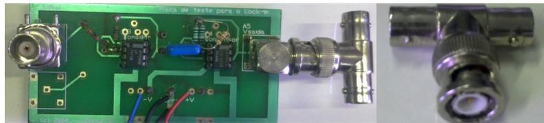
Figura 3.21: Placa de aquisição com sinal de saída derivado com conector bnc tipo T.
