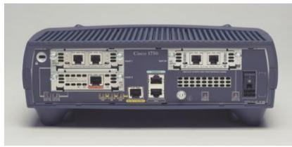
Figura 103: Roteador *Cisco* 1750 com placa FXS.
