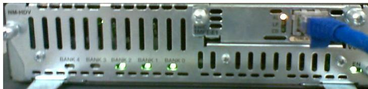
Figura 60: NM-HDV com placa VWIC-1MFT-E1.
