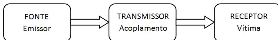
Figura 3.1. Acoplamento entre uma fonte e o receptor através de um mecanismo acoplador.
