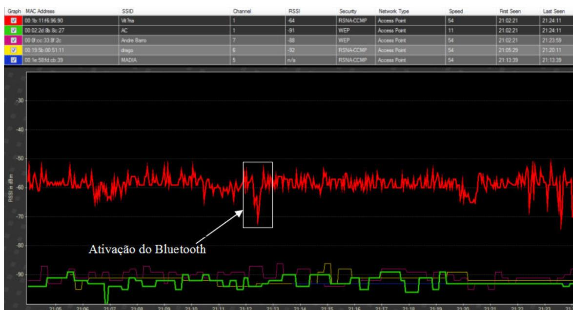
**Figura 8.45** – *Nível de sinal no receptor Wi-Fi: distância de 4,60 m.*
