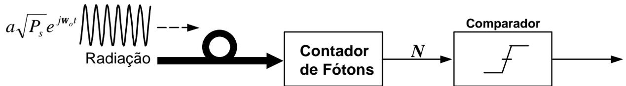
Figura 4.4 – Representação do receptor de um sistema de comunicação óptica. O parâmetro “a” modula a intensidade da radiação emitida. Se um bit ZERO for emitido então “a” é nulo e se um bit UM for emitido “a” é não nulo.
