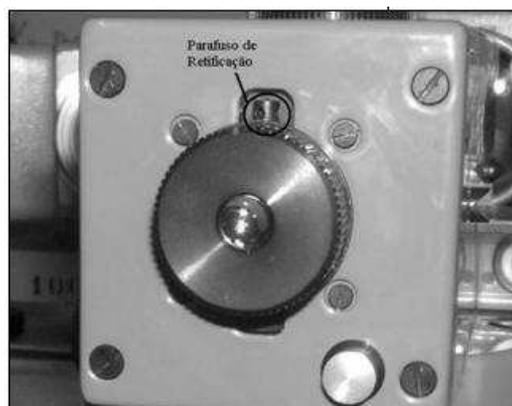
Figura 7 : Parafuso de retificação do nível SION
