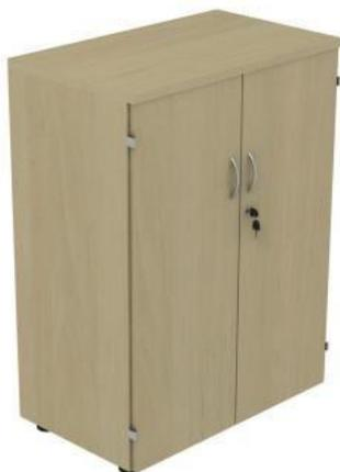
**Tampo** - Em MDP ou MDF com no mínimo 22 mm e no máximo 30 mm de espessura; Revestido em laminado melamínico texturizado de baixa pressão em ambas as faces. Cor a definir no empenho; Bordas com perfis tipo fita em PVC com no mínimo 2 mm e no máximo 3 mm de espessura, refiledas, com arestas arredondadas de raio 2,5 mm, coladas a quente pelo processo tipo hot-melt, na mesma cor do tampo;
