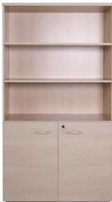
**Tampos superior e intermediário** - Em MDP ou MDF com no mínimo 22 mm e no máximo 30 mm de espessura; Revestido em laminado melamínico texturizado de baixa pressão em ambas as faces. Cor a definir no empenho; Bordas com perfis tipo fita em PVC com no mínimo 2 mm e no máximo 3 mm de espessura, refiladas, com arestas arredondadas de raio 2,5 mm, coladas a quente pelo processo tipo hot-melt, na mesma cor do tampo; Tampo intermediário acima das portas;
