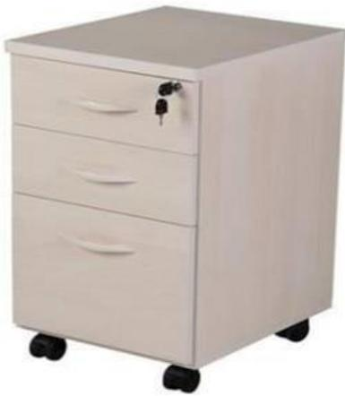
**Tampo** - Em MDP ou MDF com no mínimo 22 mm e no máximo 30 mm de espessura; Revestido em laminado melamínico texturizado de baixa pressão em ambas as faces. Cor a definir no empenho; Bordas com perfis tipo fita em PVC com no mínimo 2 mm e no máximo 3 mm de espessura, refiladas, com arestas arredondadas de raio 2,5 mm, coladas a quente pelo processo tipo hot-melt, na mesma cor do tampo;
