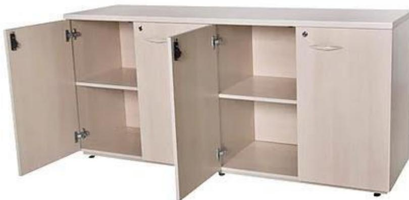
**Tampo** - Em MDP ou MDF com no mínimo 22 mm e no máximo 30 mm de espessura; Revestido em laminado melamínico texturizado de baixa pressão em ambas as faces. Cor a definir no empenho; Bordas com perfis tipo fita em PVC com no mínimo 2 mm e no máximo 3 mm de espessura, refiledas, com arestas arredondadas de raio 2,5 mm, coladas a quente pelo processo tipo hot-melt, na mesma cor do tampo;
