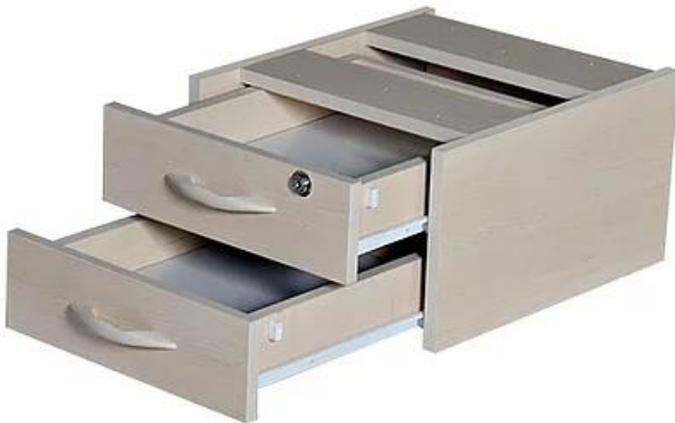
**Painéis** - Referências às: Laterais; Fundo; Inferior e superior de fixação. Laterais e fundo integrados ao painel superior de fixação e ao painel inferior que compõe a base; Em MDP ou MDF com 18 mm de espessura; Revestidos em laminado melamínico texturizado de baixa pressão em ambas as faces. Cor a definir no empenho; Bordas com perfis tipo fita em PVC com no mínimo 1 mm de espessura, refiladas, arestas arredondadas, coladas a quente pelo processo tipo hot-melt, na mesma cor dos painéis;
